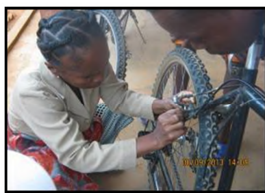
Entretien et réparation du frein (remplacement du patin)
